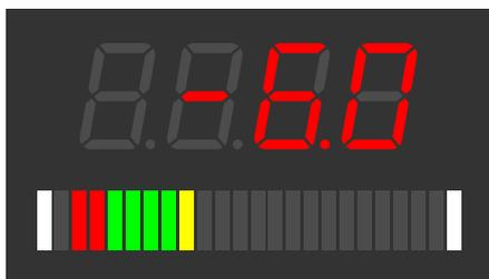
**1.3** индикатор отображает отрицательное число, находящееся ниже зоны допустимых значений (превысившее нижнюю уставку), поэтому индикация красная; на шкале красным показывается только превышающая часть значения, чтобы был виден объем превышения
