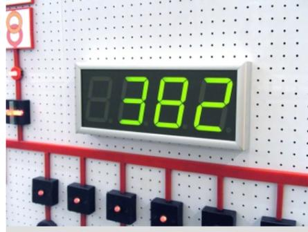
Индикатор Ин4.45. Высота символов 45 мм, 2 цвета, произвольное положение запятой, управление по интерфейсу RS-485
