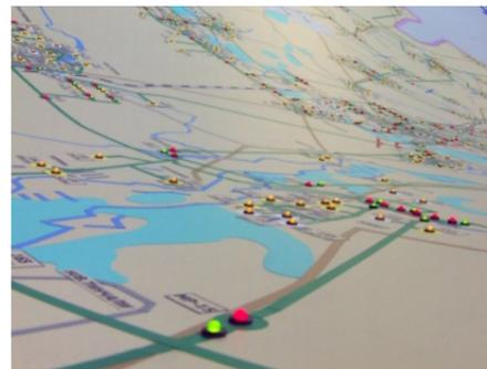
Мнемосхема выполнена в технике пленочной аппликации. На металлический лист с магнитными свойствами наклеивается один или несколько слоев самоклеящейся пленки, в т.ч. с печатным рисунком
